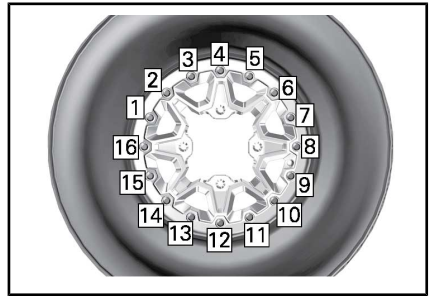
SITUAZIONE TIPICA - SEQUENZA DI SERRAGGIO FINALE
