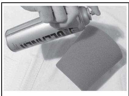
TYPISCH - SPUIT HET OP DE SCHUIMFILTER
