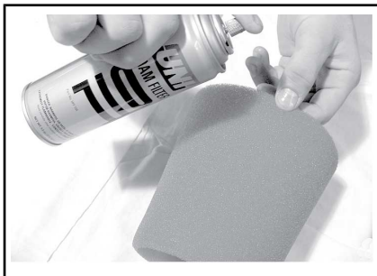
TYPISCH - FILTER MET OLIE SMEREN
