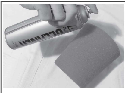
TYPISCH - SPIJT HET OP DE SCHUIMFILTER
