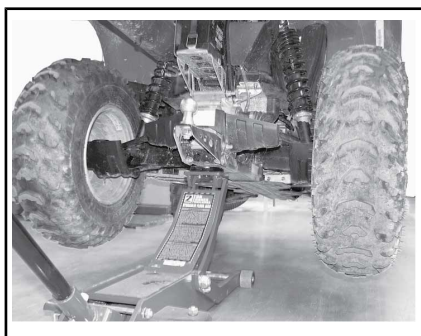
CONFIGURAZIONE TIPICA - PUNTO DI SOLLEVAMENTO POSTERIORE
