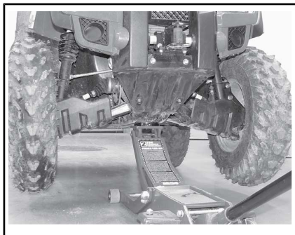
CONFIGURAZIONE TIPICA - PUNTO DI SOLLEVAMENTO ANTERIORE
