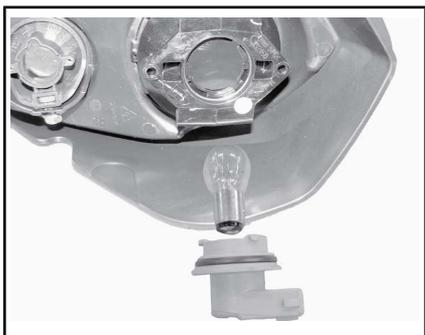
4. Retirez la douille du feu arrière. L'installation s'effectue dans l'ordre inverse de la dépose.
