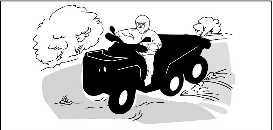
Si le véhicule se met à glisser, tournez le guidon dans la direction du glissement jusqu'à la reprise de la maîtrise du véhicule. Ne serrez jamais les freins à fond et ne bloquez jamais les roues.
