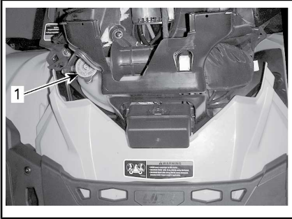
1. Depósito de refrigerante del motor
