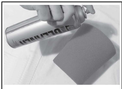
TYPIQUE - VAPORISEZ LE FILTRE EN MOUSSE
