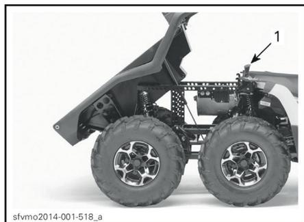
1. Рычаг разблокировки грузовой платформы
