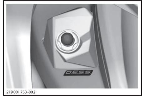
КОНТАКТНОЕ УСТРОЙСТВО СИСТЕМЫ D.E.S.S.
