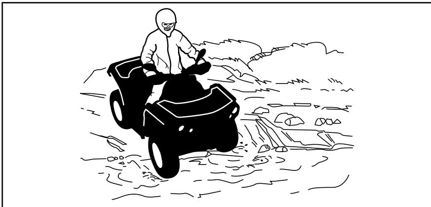
Freios molhados afetam a capacidade de frenagem do seu veículo. Certifique-se de secar os freios, aplicando-os várias vezes depois de sair da água, lama ou neve.
