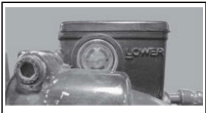
BREMSEVÆSKEBEHOLDER FOR BREMSER PÅ VENSTRE SIDE BAK
