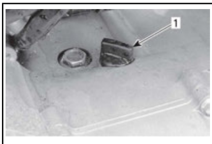
VULPLUG — LINKERKANT VAN DE MOTOR
