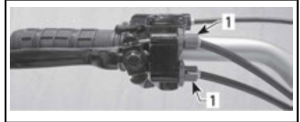
1. Einstellschrauben am Hebel
