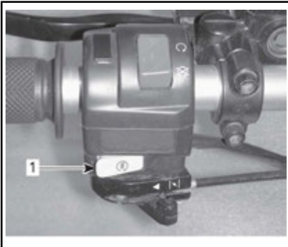
CHOKE BIS ZUM ANSCHLAG BETÄTIGT
