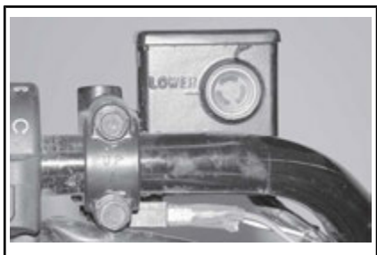
TÍPICO — RESERVATÓRIO DE FLUIDO DO FREIO TRASEIRO ESQUERDO
