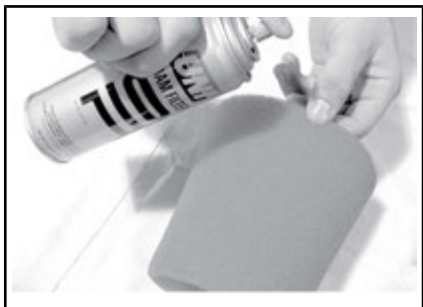
TÍPICA - UNTE O ELEMENTO DE ESPUMA DO FILTRO COM ÓLEO
