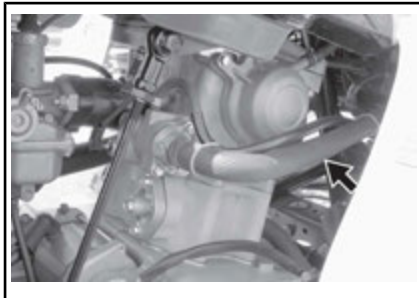
1. Bujão de drenagem do sistema de arrefecimento
