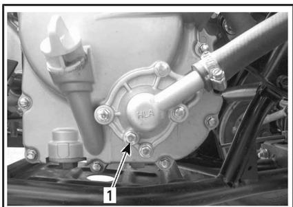
1. Bouchon de vidange du système de refroidissement
