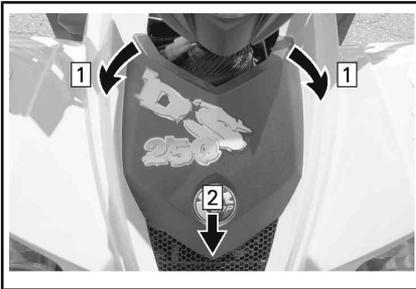
Étape 1 : Tirer les languettes avant des œillets en caoutchouc.
