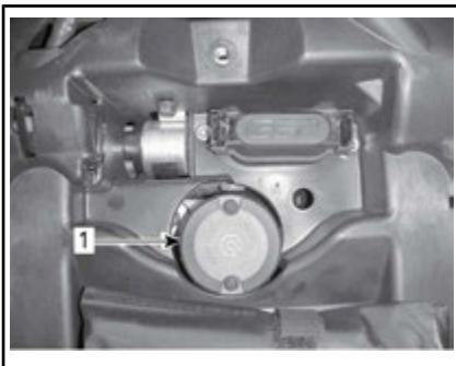
1. Serbatoio liquido dei freni posteriori
