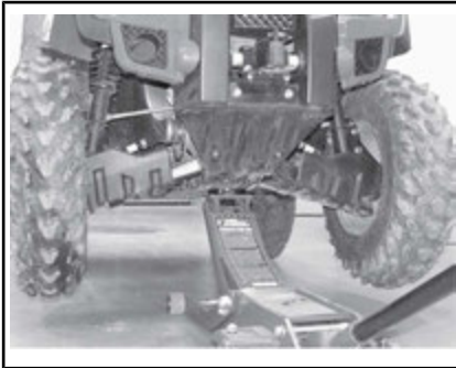
CONFIGURAZIONE TIPICA - PUNTO DI SOLLEVAMENTO ANTERIORE
