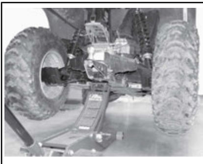
CONFIGURAZIONE TIPICA - PUNTO DI SOLLEVAMENTO POSTERIORE
