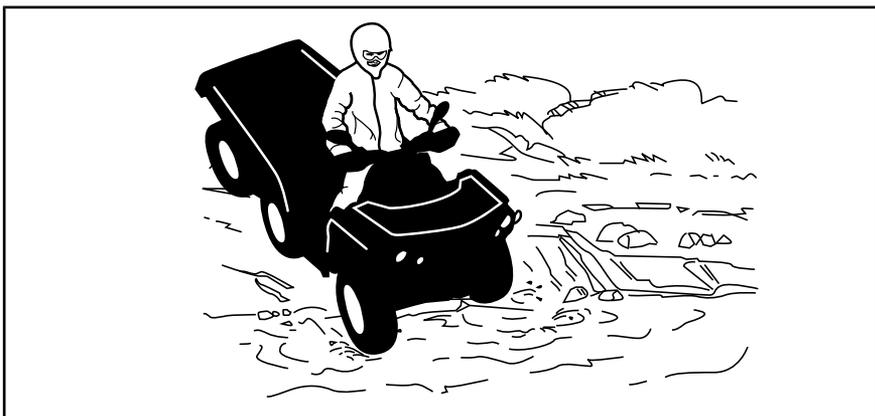
Des freins mouillés réduisent la capacité de freinage. Après être sorti de l'eau, de la neige ou de la boue, actionnez les freins quelques fois pour que la chaleur de la friction sèche les freins. Prévoyez davantage de distance pour freiner.
