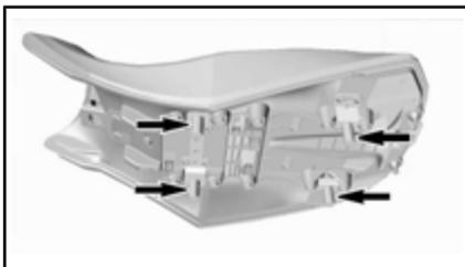
**PUNTOS PARA LA INSTALACIÓN DE LOS BLOQUEOS DEL ELEVADOR**
