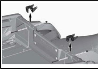
3. Introduzca las placas esquineras de las bisagras inferiores a ambos lados.
