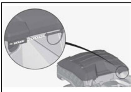
4. Retire la cubierta de la plataforma de carga.
