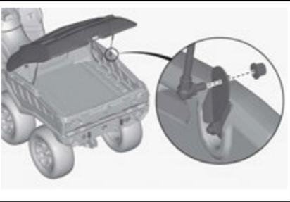
9. Instale el extremo superior del amortiguador y atorníllelo en su lugar.
