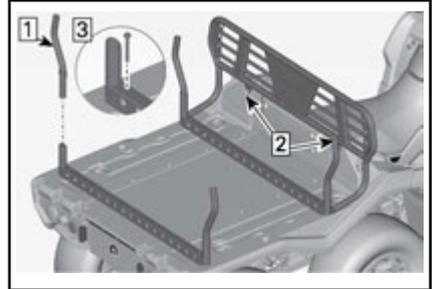
2. Retire los tubos de la estructura.
