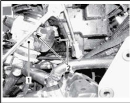
Inserte la aguja de la lata del lubricante en el extremo del ajustador del cable del acelerador.
