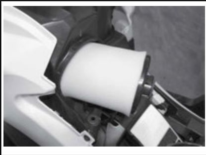
FJERNING AV LUFTFILTER
