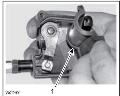
1. Protezione interna dell'alloggiamento
