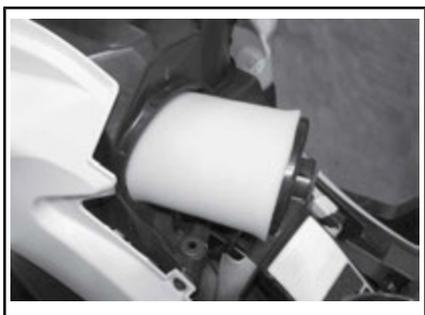
**RIMOZIONE DEL FILTRO DELL'ARIA**
