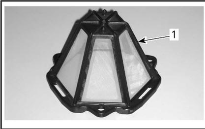
1. Filtro dell'aria CVT (tipo clip-on)
