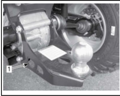
TYYPILLINEN - KIINNITYSKOHTA TAKANA
