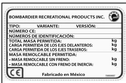
UBICACIÓN: BAJO EL ASIENTO, SOBRE LA SECCIÓN SUPERIOR DEL BASTIDOR
