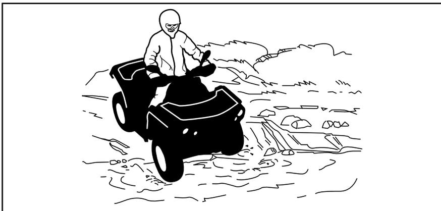
Si los frenos están húmedos, la capacidad de frenado del vehículo se ve afectada. Asegúrese de que se sequen los frenos; para ello, acci6nelos varias veces despu3s de salir del agua, del barro o de la nieve con el veh3culo. Tenga en cuenta la necesidad de una mayor distancia para el frenado.
