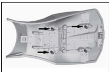
**PUNTOS PARA LA INSTALACIÓN DE LOS BLOQUEOS DEL ELEVADOR**
