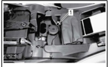
1. Behälter für Bremsflüssigkeit der hinteren Bremse
