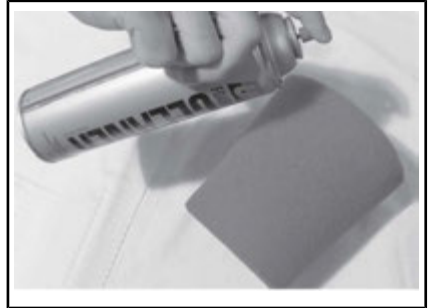
TYPISCH - SCHAUMSTOFFFILTER BE-SPRÜHEN
