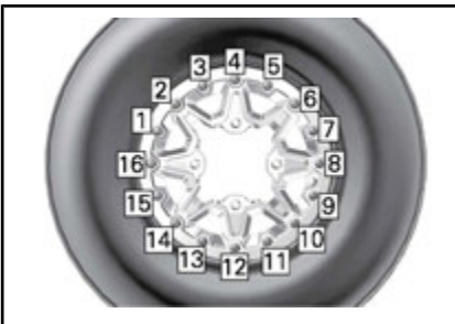
TYPEBILDE – TILTREKKINGSREKKEFØLGE SISTE TILTREKKING
