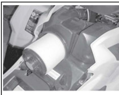
**RIMOZIONE DEL FILTRO DELL'ARIA**
