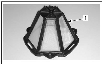
1. Filtro dell'aria CVT (tipo clip-on)
