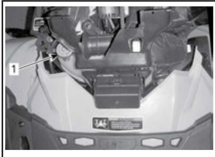
1. Tappo del serbatoio liquido refrigerante motore
