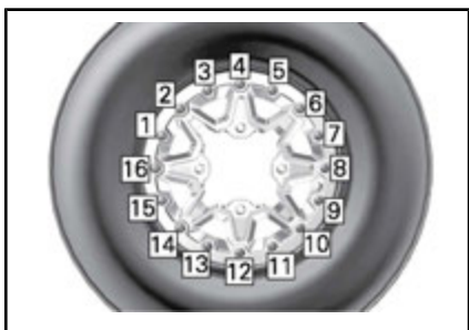
TYPIQUE - SÉQUENCE DE SERRAGE FINAL
