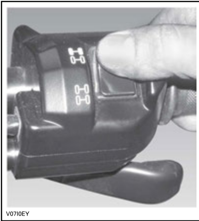
MODE 2 ROUES MOTRICES - TYPIQUE
