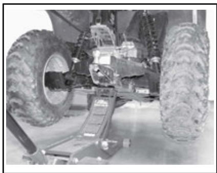
TYPIQUE — POINT DE LEVAGE ARRIÈRE
