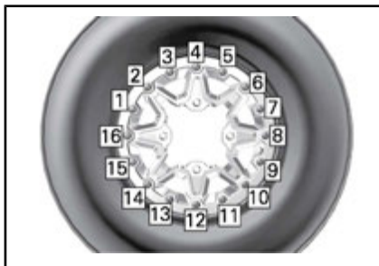
TYYPILLINEN - LOPULLINEN KIRISTYSJÄRJESTYS
