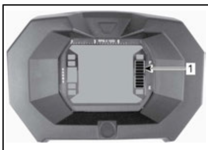
1. Visualización del nivel de combustible
