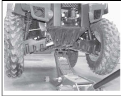
TÍPICO - PUNTO DE ELEVACIÓN DELANTERO
