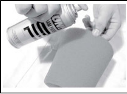
TÍPICO - LUBRIQUE EL FILTRO DE ESPUMA.
