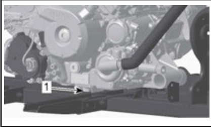
1. Tapón de drenaje
