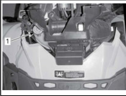
1. Depósito de refrigerante del motor
