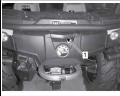
1. Seguro del compartimento de almacenamiento trasero
