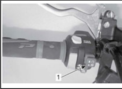
1. Interruptor de parada de emergencia del motor
