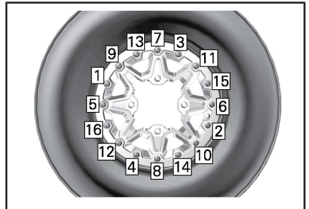
VANLIG – ÅTDRAGNINGSEKvens
