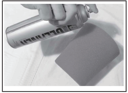
TYYPILLINEN – SUIHKUTA VAAHTOMUOVISUODATTIMEEN
