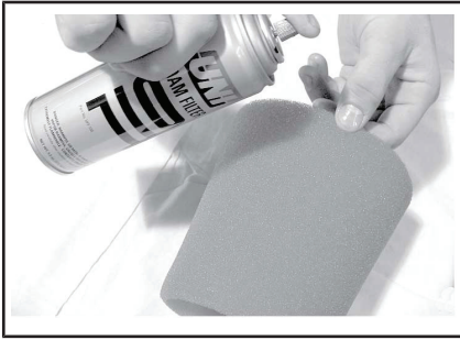
TYYPILLINEN – ÖLJYÄ VAAHTOMUOVISUODATIN
