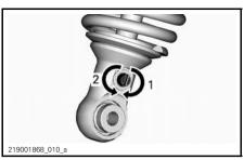
REBOUND DAMPING - BOTTOM OF SHOCK ABSORBER
