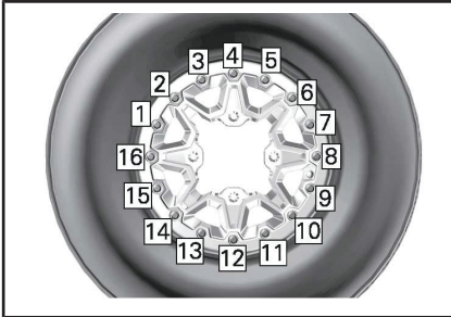
TYPIQUE - SÉQUENCE DE SERRAGE FINAL
