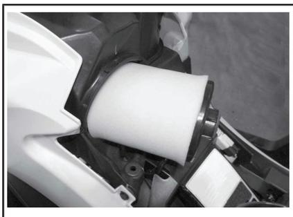
**RIMOZIONE DEL FILTRO DELL'ARIA**
