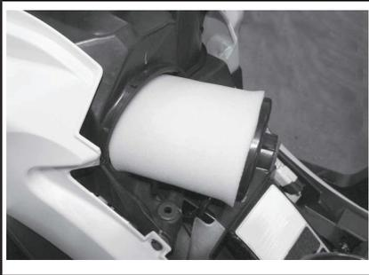
*DÉPOSE DU FILTRE À AIR*
