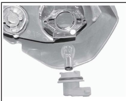
4. Retirez la douille du feu arrière. Pour l'installation, inversez les étapes de la dépose.
