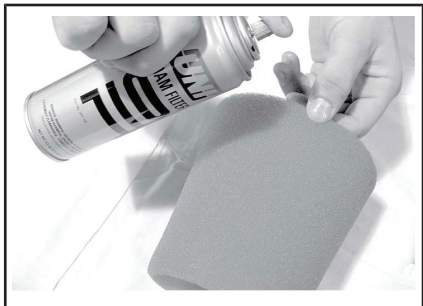
TÍPICO - LUBRIQUE EL FILTRO DE ESPUMA.
