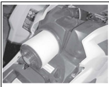
FJERNING AV LUFTFILTER
