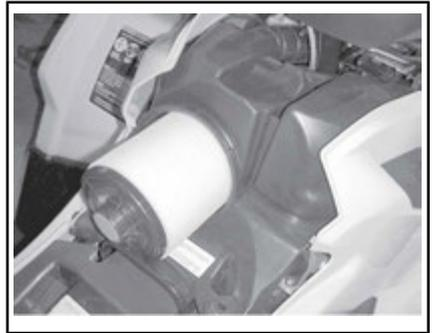
**RIMOZIONE DEL FILTRO DELL'ARIA**
