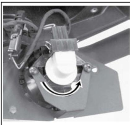
*CONFIGURAZIONE TIPICA: RUOTARE LA LAMPADINA IN SENSO ANTIORARIO*
