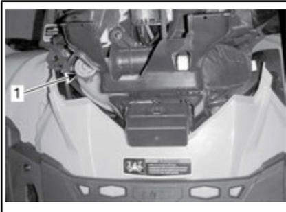
1. Tappo del serbatoio liquido refrigerante motore
