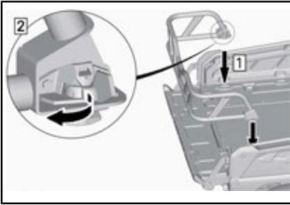
5. Installare l'estensione del vano di carico.
