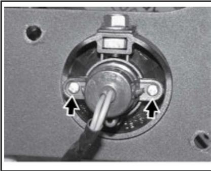
**DESATORNILLE LOS TORNILLOS DE FIJACIÓN DE LA BOMBILLA DEL INTERMITENTE TRASERO**
