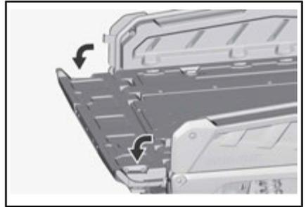
3. Coloque las abrazaderas del soporte en la puerta trasera.
