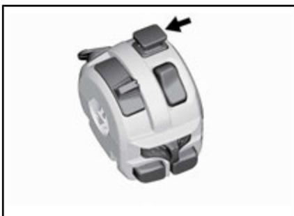
Pulse el botón hacia abajo para encender las luces de emergencia. Tire de él hacia arriba para apagarlas.
