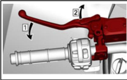
Schritt 1: Betätigen Sie die Bremsen
