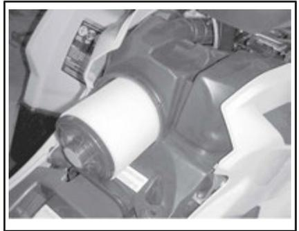
**AUSBAU DES LUFTFILTERS****Entleeren und Inspektion des Motorluftfilterkastens**
