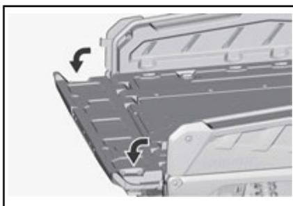
3. Entfernen Sie die Federstecker der Verriegelungsgriffe an beiden Seiten.
