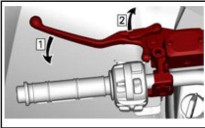
Schritt 1: Betätigen Sie die Bremsen
