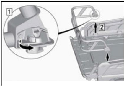
3. Entfernen Sie die Stützhalterungen von der Ladeklappe.
