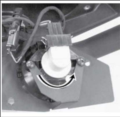
*TYPISCH: GLÜHLAMPE GEGEN UHRZEIGERSINN DREHEN*
