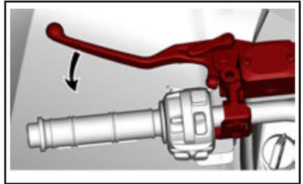
Die Bremswirkung ist proportional zur Kraft, die auf den Hebel ausgeübt wird.
