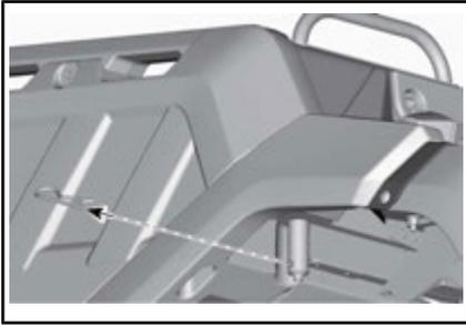
4. Entfernen Sie die Verriegelungsgriffe an beiden Seiten.
