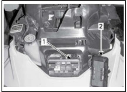
1. Vorderer Sicherungskasten
