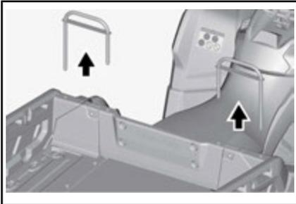
5. Heben Sie die Seitenwand hoch und entfernen Sie sie.
