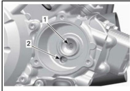
1. Auslass-Bohrung zur Ölspeisung des Motors
