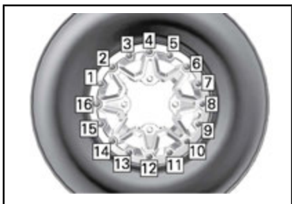
TYPISCH - LAATSTE AANDRAAIVOLGORDE
