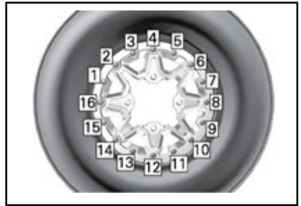
SITUAZIONE TIPICA - SEQUENZA DI SERRAGGIO FINALE
