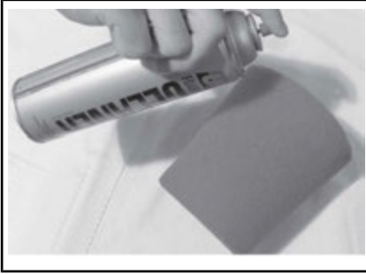
TYYPILLINEN - SUIHKUTA VAAHTOMUOVISUODATTIMEEN
