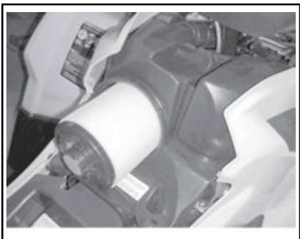
AUSBAU DES LUFTFILTERS
