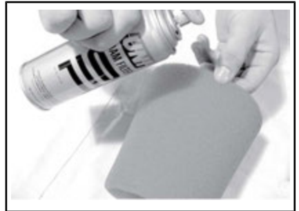
TYPISCH - SCHAUMFILTERELEMENT ÖLEN
