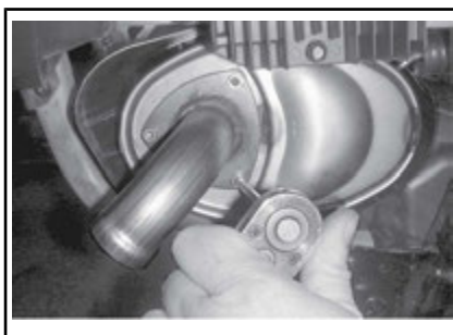
TYPISCH - ABGASROHR ENTFERNEN
