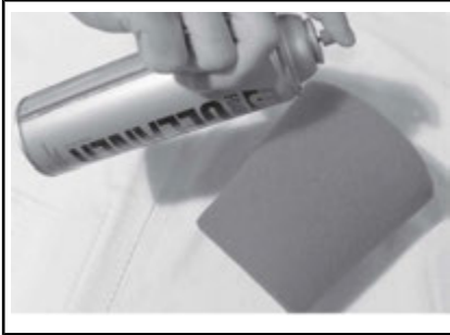
TYPISCH - SCHAUMSTOFFFILTER BE- SPRÜHEN
