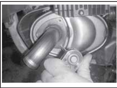
TYPIQUE - RETRAIT DU TUYAU ARRIÈRE
