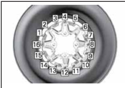
TYPIQUE - SÉQUENCE DE SERRAGE FINAL
