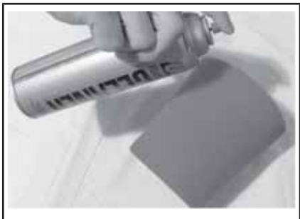
TYPIQUE - VAPORISEZ LE FILTRE EN MOUSSE
