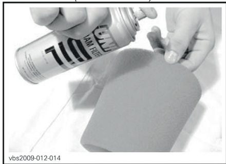
ТИПОВОЙ ВАРИАНТ - НАНЕСИТЕ МАСЛО НА ФИЛЬТРУЮЩИЙ ЭЛЕМЕНТ
