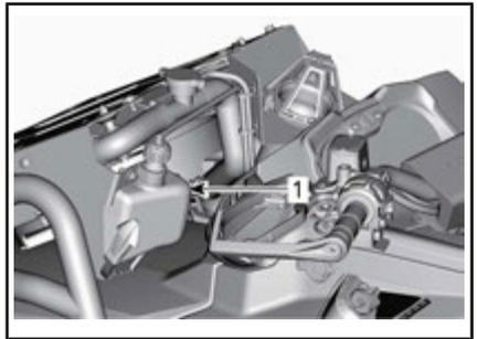
1. Reservatório de líquido de arrefecimento do motor
