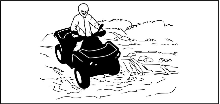
A água afeta a capacidade de frenagem do seu veículo. Certifique-se de secar os freios, aplicando-os várias vezes depois de sair da água.
