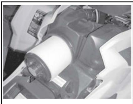
**RIMOZIONE DEL FILTRO DELL'ARIA**
