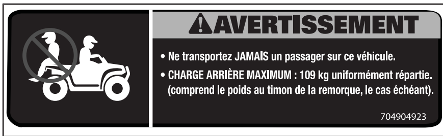
ÉTIQUETTE 6 - OUTLANDER X mr (570) : AILE ARRIÈRE (REPORTEZ-VOUS À LA FICHE TECHNIQUE POUR LES VALEURS)
