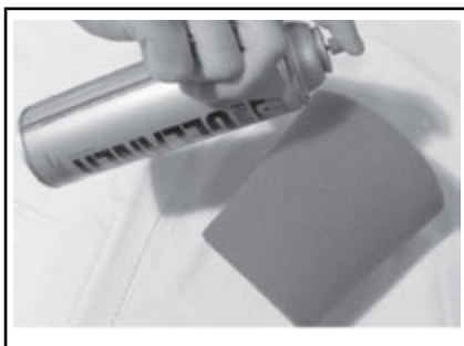
TYYPILLINEN - SUIHKUTA VAAHTOMUOVISUODATTIMEEN
