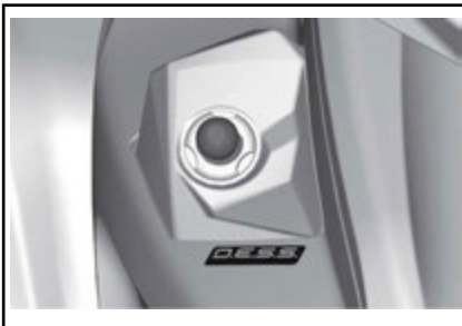
ANCLAJE D.E.S.S. DEL MOTOR
