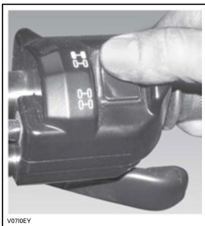
MODO DE TRACCIÓN EN DOS RUEDAS (2WD)
