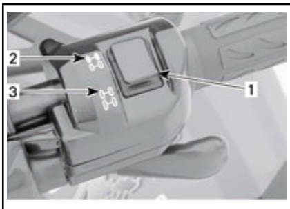
MODO DE TRACCIÓN EN LAS CUATRO RUEDAS (4WD)
