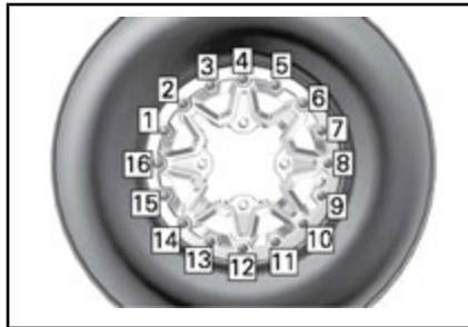
TYPIQUE - SÉQUENCE DE SERRAGE FINALE
