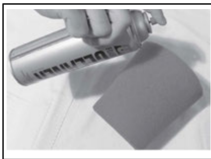
TYPIQUE - VAPORISEZ LE FILTRE EN MOUSSE
